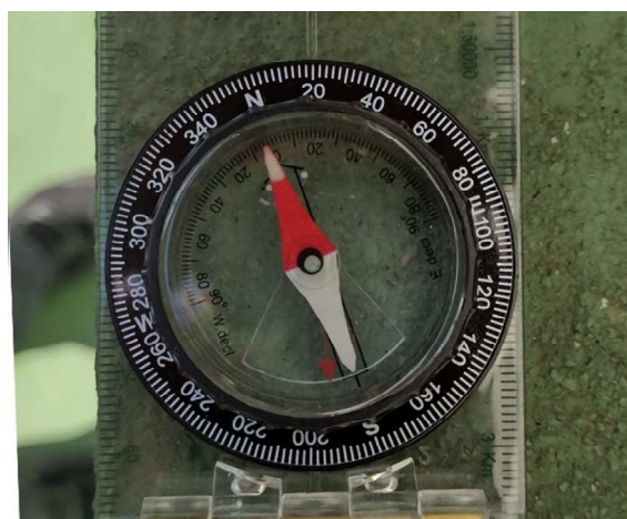
Foto 04 – Norte magnético obtido através de bússola às 15h48min, posicionada na lateral direita (comprimento) do ginásio poliesportivo, de quem o olha de frente (conforme foto 02), acreditando que com base nas coordenadas geográficas referenciadas neste documento será possível o cálculo do azimute atual de forma eficiente.
