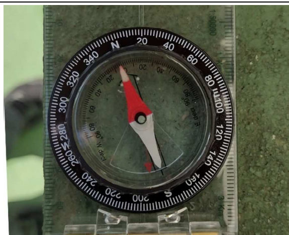
Foto 05 – Norte magnético obtido através de bússola às 15h48min, posicionada na lateral direita (comprimento) do ginásio poliesportivo, de quem o olha de frente (conforme foto 02), acreditando que com base nas coordenadas geográficas referenciadas neste documento será possível o cálculo do azimute atual de forma eficiente.
